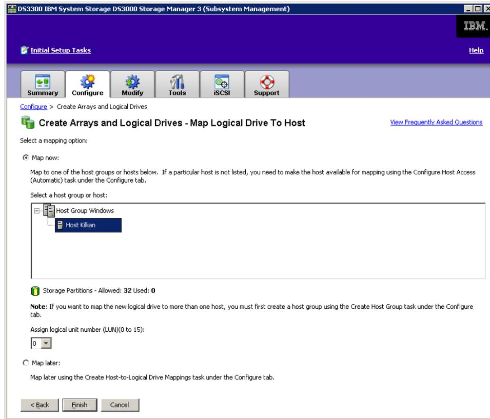
Figure 33: DS3000 Storage Manager Logical Drive Configuration Screen Part 3
