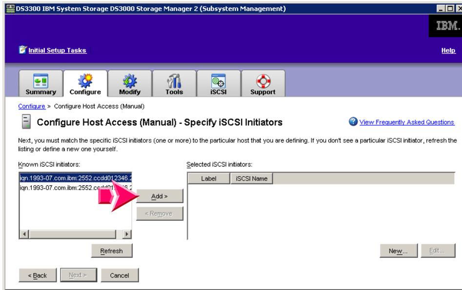
Figure 92: IBM DS3000 Configure Host Access Window
